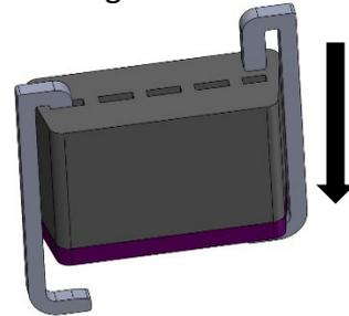
OBD-Buchse mithilfe einer Zange bis Anschlag herausziehen
